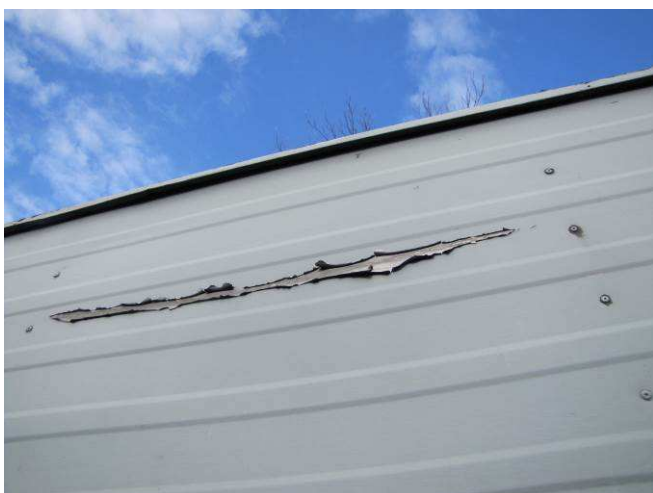
przytarte obłachowanie skrzyni ładunkowej
