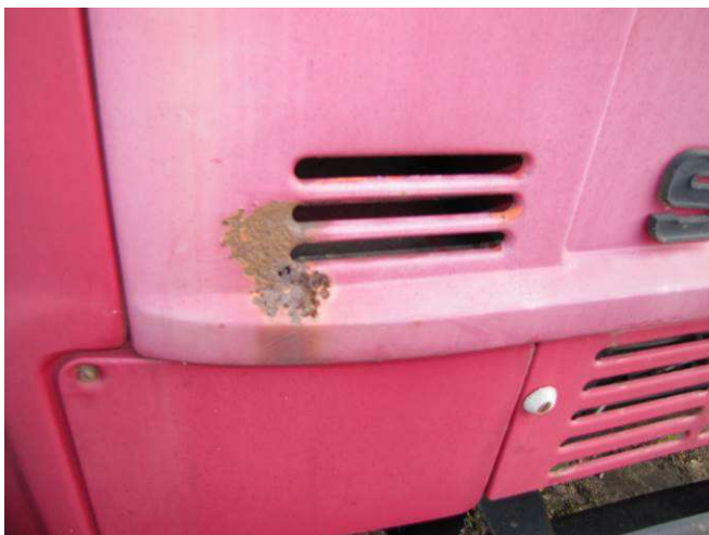
korozja oraz ubytki powłoki lakierniczej oblachowania przedniej maskownicy
