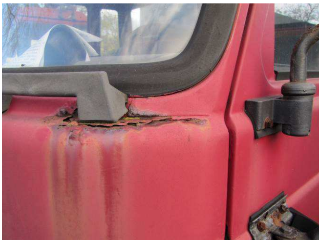
ogniska korozji obłachowania pod szybą czołową z lewej strony
