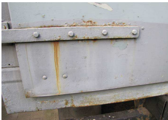
korozja w okolicach mocowania zawiasu tylnych drzwi skrzyni ładunkowej
