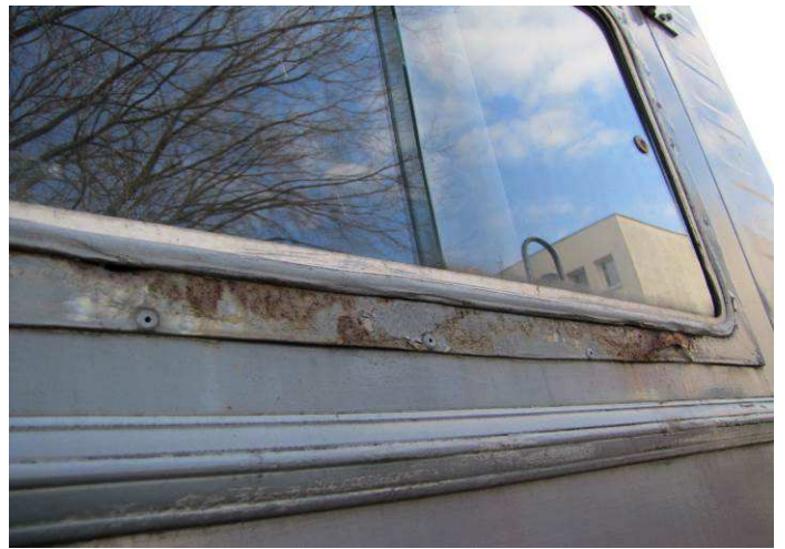
skorodowane podszycie skrzyni ładunkowej z prawej strony
