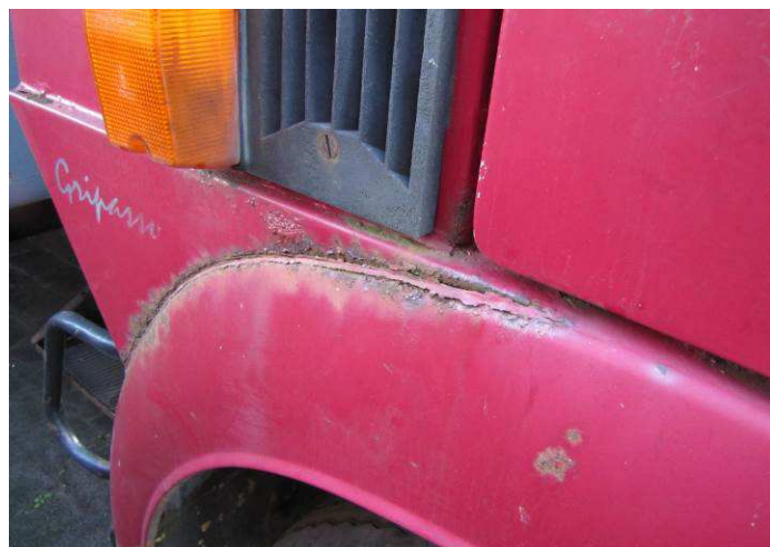
silnie skorodowane nadkole z prawej strony kabiny kierowcy
