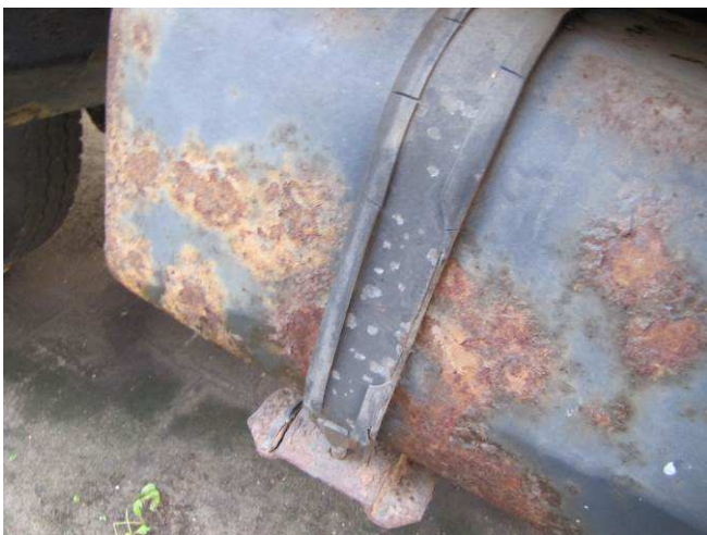
silnie skorodowany zbiornik paliwa
