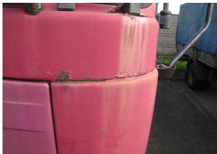
skorodowane oblachowanie lewego przedniego naroża kabiny
