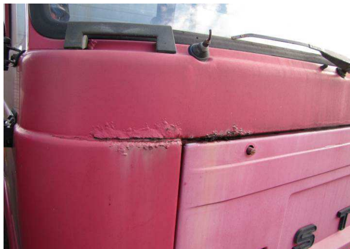
korozja oraz ubytki powłoki lakierniczej oblachowania przedniego prawego naroża kabiny kierowcy
