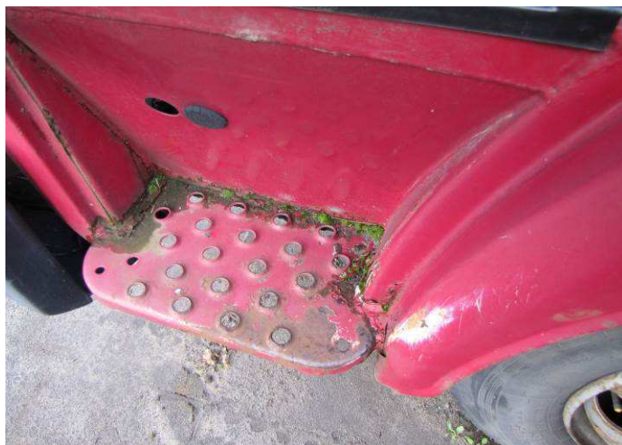
skorodowany stopień wejścia z lewej strony kabiny kierowcy
