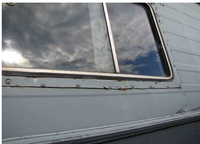
korozja i ubytki powłoki lakierniczej podszybia skrzyni ładunkowej
